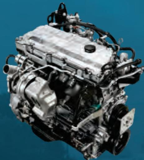
El motor 4HK1 TCN del NPR75 y NPR75 Doble Cabina con 153 CV genera menos emisiones contaminantes y mayor eficiencia de combustible.
